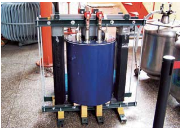
图3 45kVA单相高温超导变压器样机
