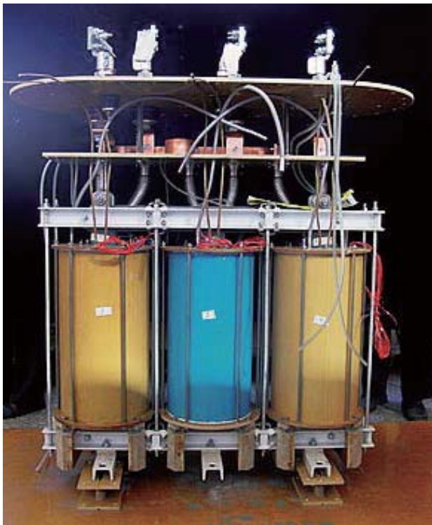
图2 26kVA三相超导变压器样机
