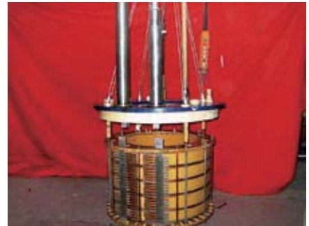
图4 630kVA三相高温超导变压器用超导绕组
