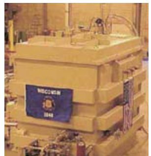
(d)美国Waukesha公司研制的5/10MVA超导变压器
