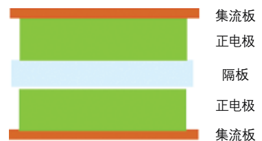
图6 超级电容器的结构和原理
