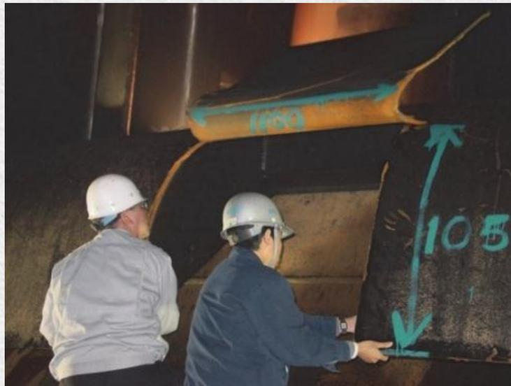
三峡10号机组在运行过程中振动摆度突然增大，系统诊断确定其原因为机组水力失衡。随后停机检查发现有数块座环导流板破裂，经补焊加强筋加固后，机组运行恢复正常。
