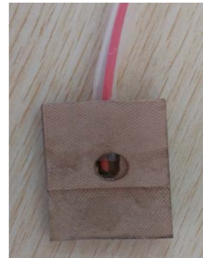
带绝缘导管的辐向垫块
