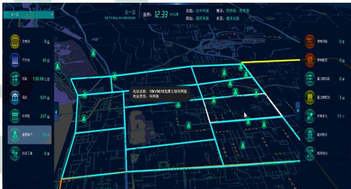
挖掘应用智能电表大数据，利用GIS平台配网拓扑关系逐级研判配变、支线、线路停运状态，解决配电自动化暂未覆盖区域内设备停运无法准确掌握的难题，为配网设备装上了“眼睛”。
