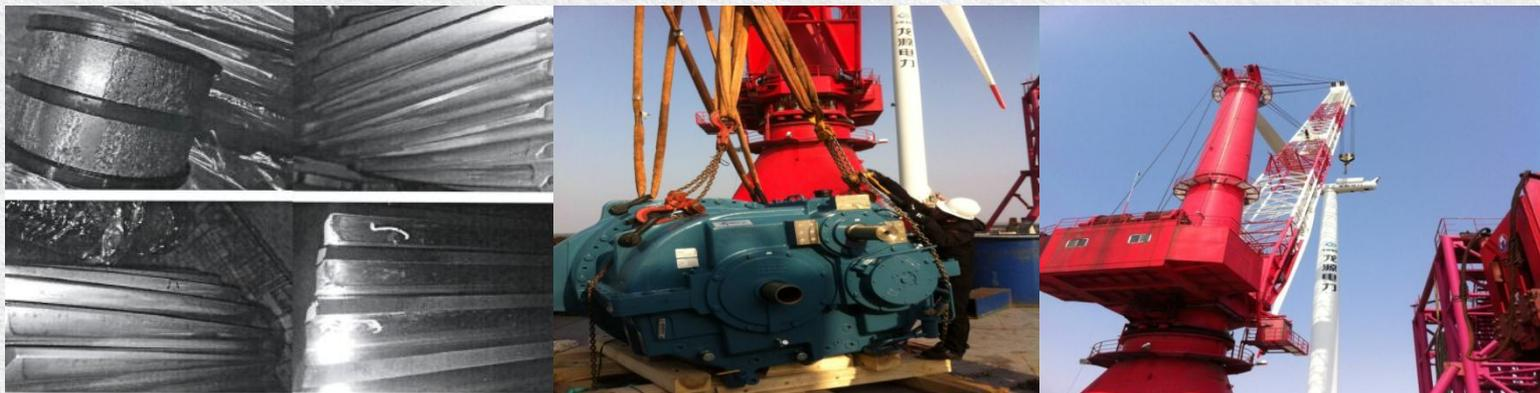
齿轮箱出现问题较多，如其中1台，齿轮箱过滤器堵塞，滤芯、滤筒中存在大量铁屑，内窥镜检查发现行星轮轴承滚道剥落，原因轴承材料存在局部缺陷。
