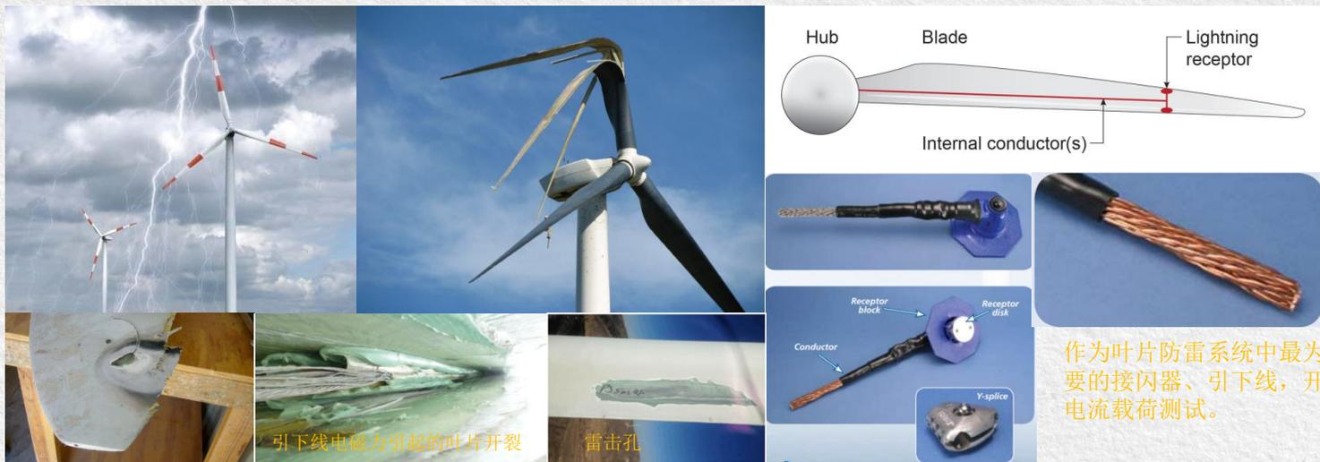
作为叶片防雷系统中最为重要的接闪器、引下线，开展电流载荷测试。
