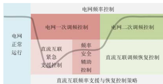
图1 直流互联频率支援与恢复控制策略
