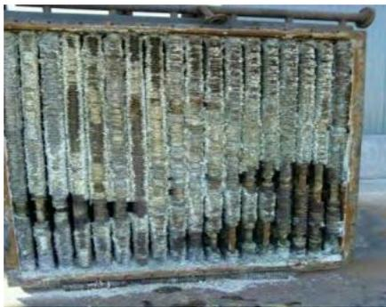
图1 某火电厂低温省煤器低温腐蚀情况
