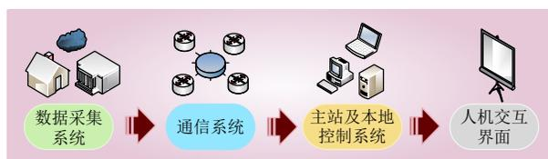
图 1 主动配电网信息侧组织架构
