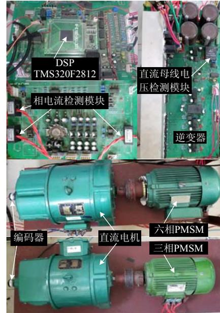
图9 实验样机图
