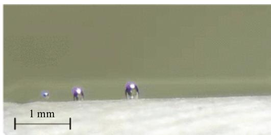
图2 160.5 ℃下绝缘纸表面的气泡<sup>[27]</sup>
