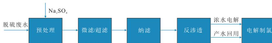
图 5 电解脱硫废水制氯典型工艺流程
