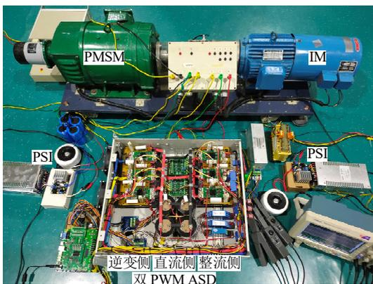
图 4 双 PWM 调速系统实验装置
