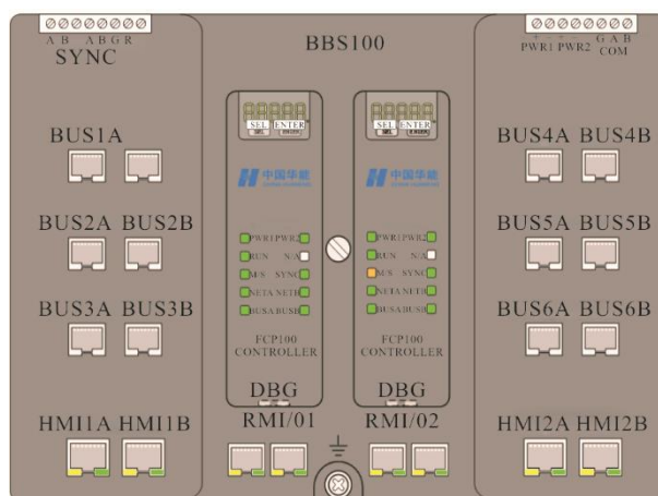
图3 冗余控制器及配套底座接口示意
