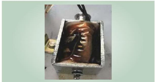
图 5 线圈击穿实验示意
