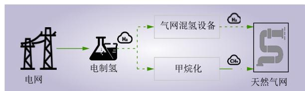
图 5 电转氢和电转甲烷流程
