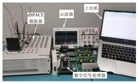
图 4 硬件在环实验装置
