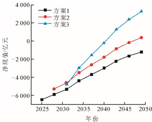
图 5 甲烷干重整利用 CO<sub>2</sub> 不同方案下净现值变化
