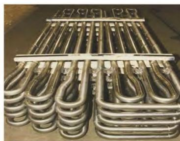
图2 过热器结构
