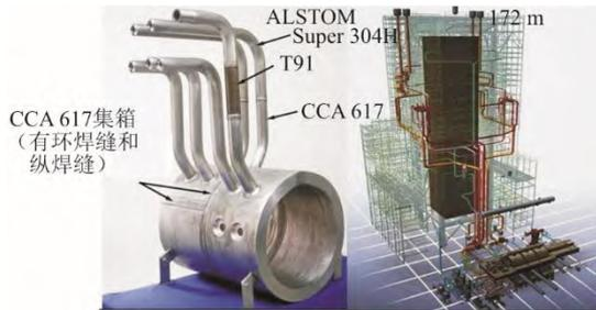
图 3 锅炉焊接集箱及接管实体模型和主蒸汽管道布局
