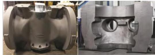
a) Haynes282 阀体 b) Alloy625 高压缸铸件
