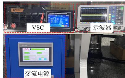
图 16 单端 MMC 动模实验装置图
