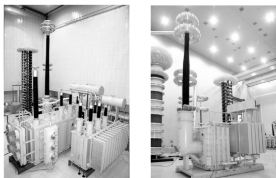
图 3 试验中的特高压变压器(左)和并联电抗器(右)
