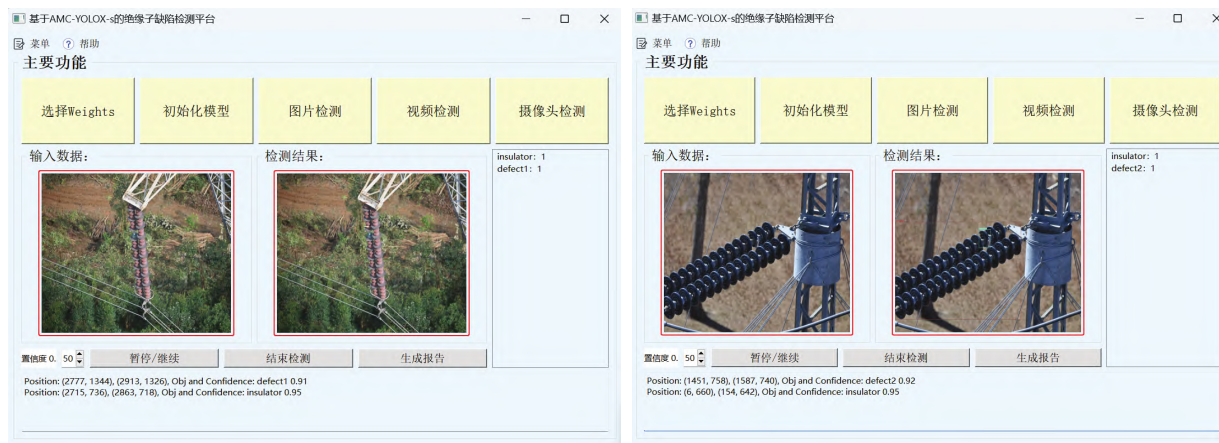
图 11 基于 AMC-YOLOX-s 的绝缘子缺陷检测平台
